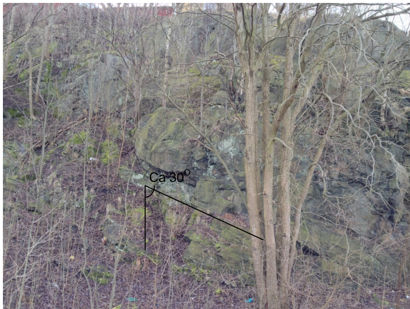
Foto 2. Brant bergsparti med sprickriktning
